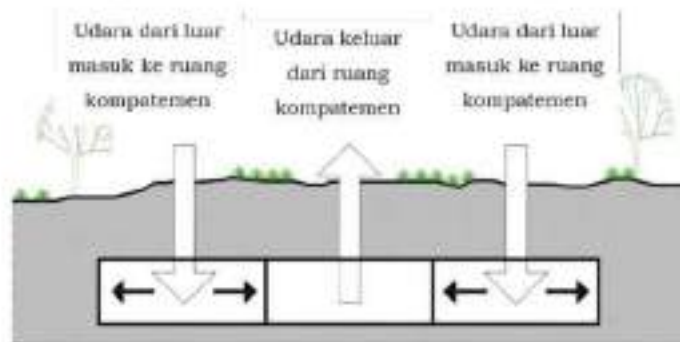
Gambar II.327 Contoh Sistem Mekanikal Bangunan Bawah Tanah
