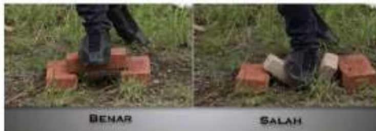
Gambar II.372 Pengujian Sederhana Kekuatan Batu Bata
