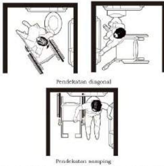
Gambar II.202. Pergerakan pengguna kursi roda ke dan dari kloset duduk menggunakan pendekatan diagonal dan pendekatan samping
