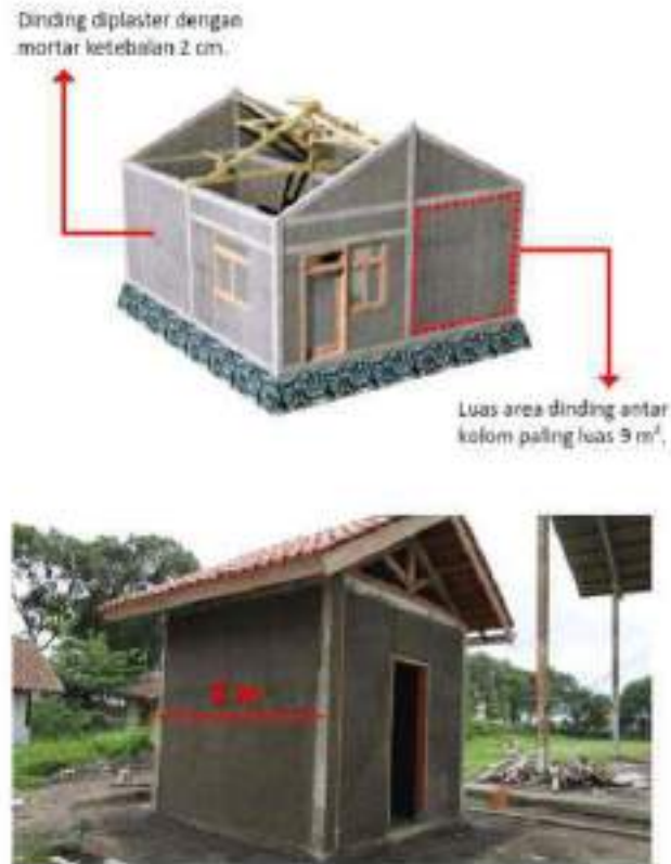
Gambar II.401 Luas Maksimum Dinding dan Jarak Maksimum Antar Kolom
