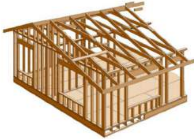
Gambar Il. 34 Semua komponen struktur kayu harus dirangkai, diangker, dikencangkan, dan dibuat kaku sehingga memiliki kekuatan dan kekakuan.
