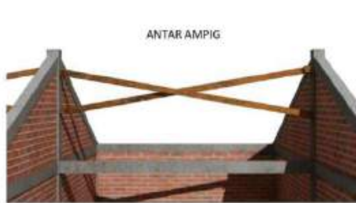
Gambar II.394 Ikatan Angin Sebagai Pengikat Antar Gunung-Gunung/ Ampig
