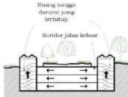
Gambar B.320 Contoh Jalur Penyelamatan Untuk Bangunan
