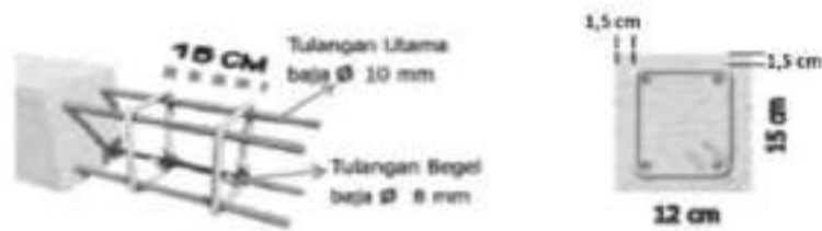
Gambar II.380 Dimensi Tulangan Balok Keliling/ Ring
