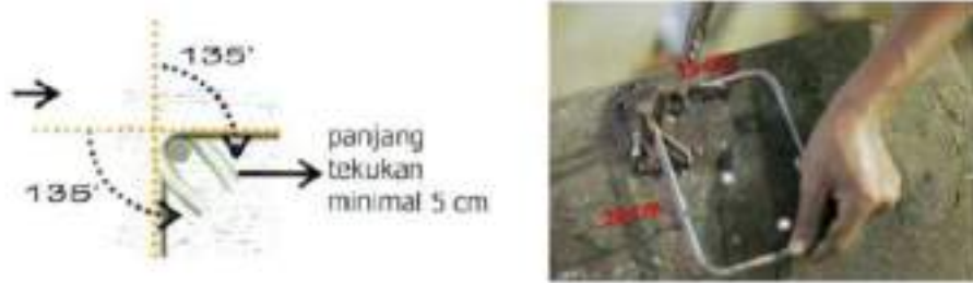
Gambar II.382 Tekukan Ujung Tulangan Begel
