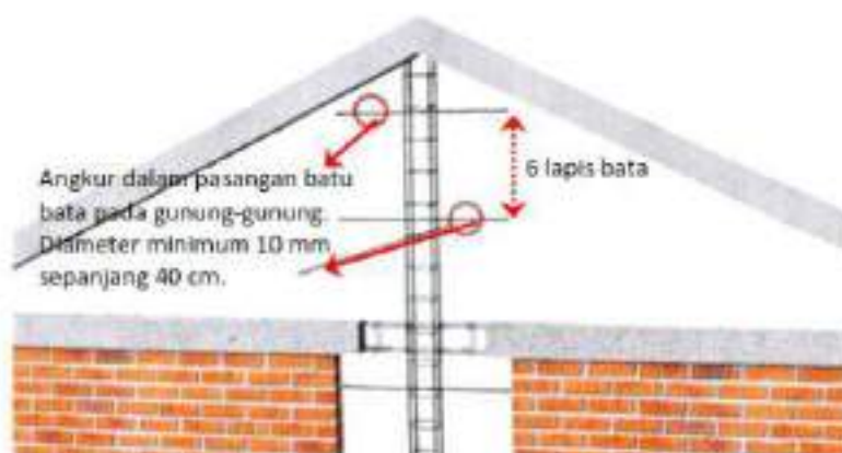
Gambar [L.411] Hubungan Angkur Pada Gunung-Gunung/ Angkur
