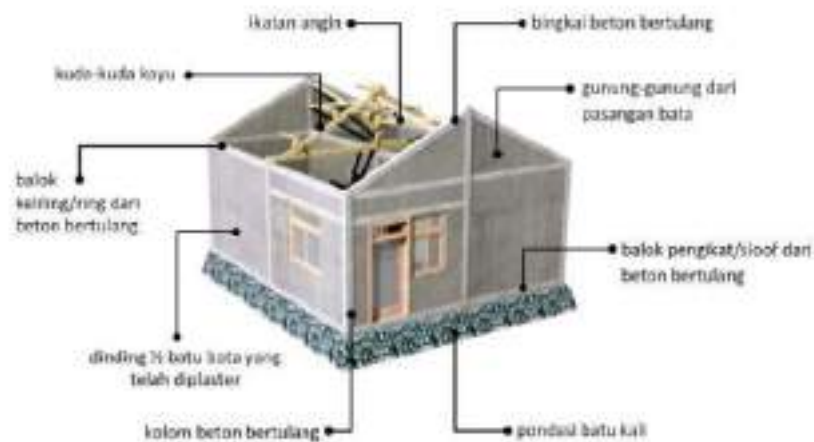
Gambar II.360 Struktur Bangunan Rumah Tinggal Tunggal
