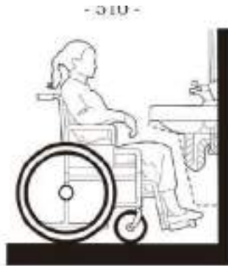
Gambar H.211. Perletakan bak cuci tangan harus mudah diakses oleh pengguna kursi roda
