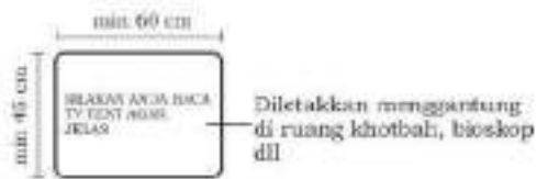
Gambar II.246. Dimensi minimum fasilitas TV text yang diletakkan di area publik
