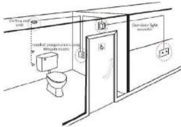
Gambar II.205. Mekanisme panic button pada toilet penyandang disabilitas
