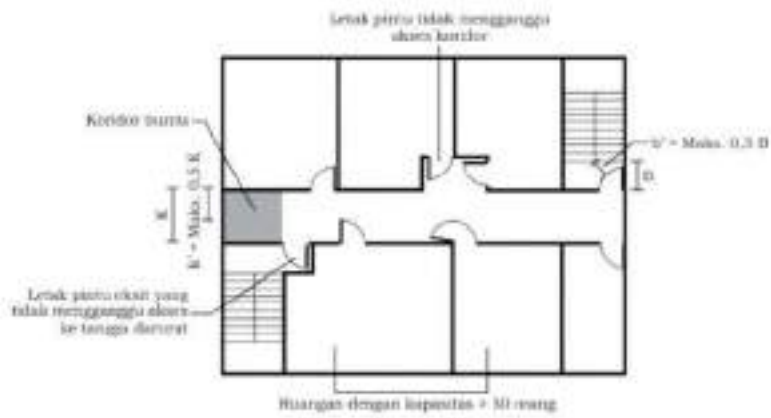
Gambar 2.80. Contoh penerapan akses eksit pada koridor buntu
