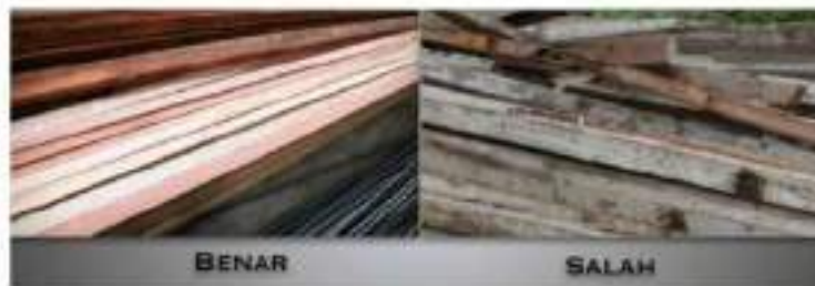
Gambar II.375 Kayu Yang Baik Digunakan Dalam Pembangunan
