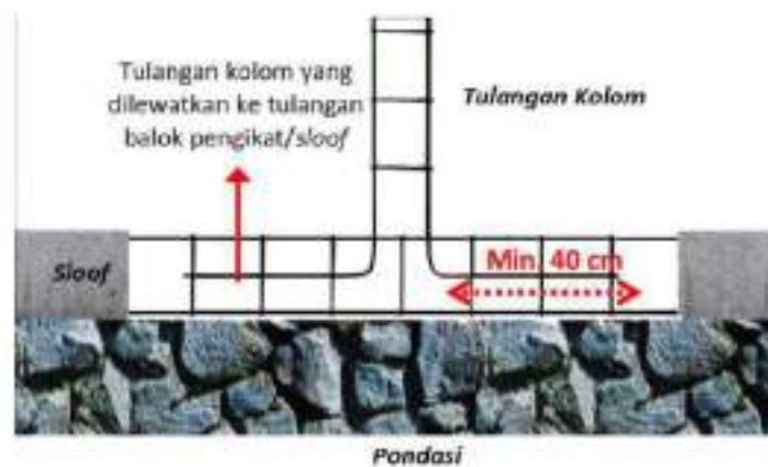
Gambar II.404 Detail Hubungan Balok Pengikat/ Sloof dengan Kolom
