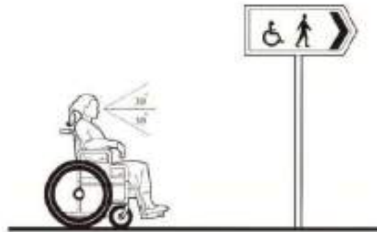
Gambar II.249. Perletakan rambu sesuai jarak dan sudut pandang
