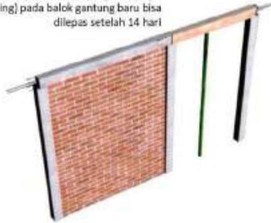
Gambar II.421 Pelepasan Cetakan/ Bekisting
