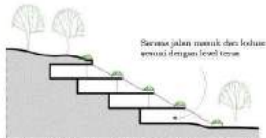
Gambar II.343 Contoh Sarana Jalan Masuk dan Keluar Sesuai dengan Level Teras
