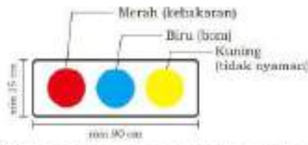
Gambar II.248. Alarm lampu darurat untuk penyandang disabilitas rangka
