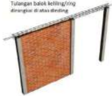
Gambar II.419 Perangkaian Tulangan Balok Keliling/ Ring Di Atas Dinding
