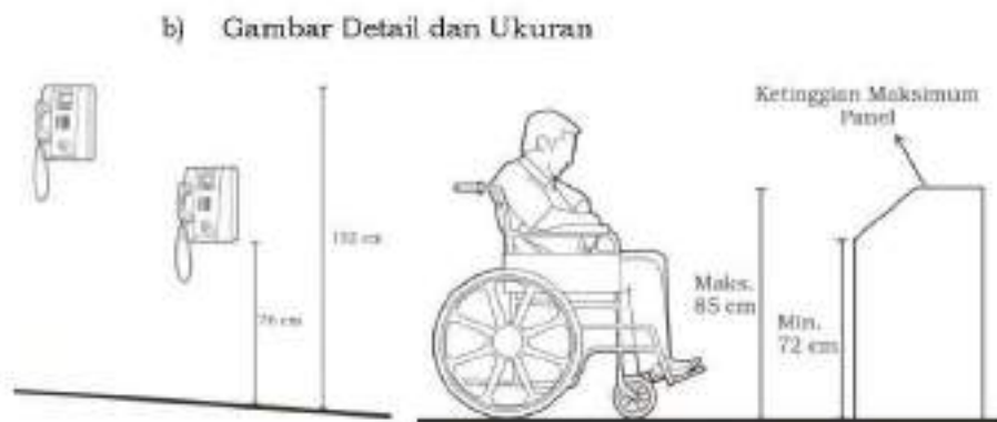
Gambar 3.43. Dimensi meja informasi dan perletakan telepon umum
