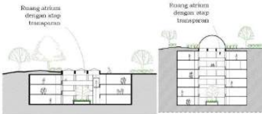
Gambar II.312 Contoh Bangunan Bawah Tanah dengan Pola Atrium (1/2)
