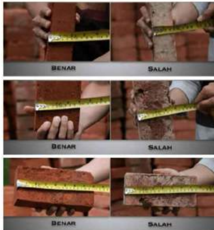
Gambar II.373 Dimensi Batu Bata Yang Baik Digunakan Dalam Pembangunan
